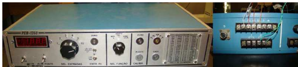
Figura 3.38 – Sistema para ponte da empresa Sodmex, modelo PEB-1350, e as ligações feitas no painel traseiro.
