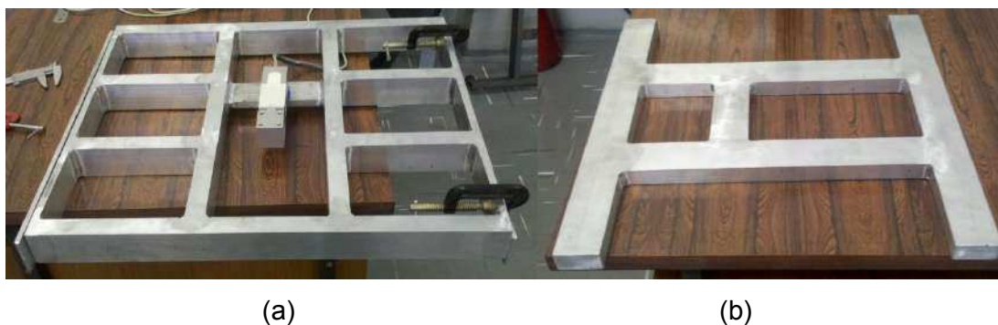
Figura 4.10 – (a) Base do assento com célula de carga instalada (b) Parte superior da estrutura a ser fixada na célula de carga.
