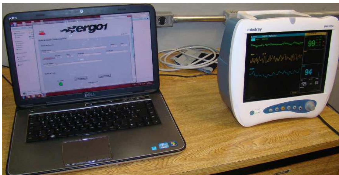
Figura 4.36 – Computador rodando o aplicativo em LabVIEW que controla o ERGO1 e o PM-7000 para monitoramento da frequência cardíaca e pressão sanguínea.
