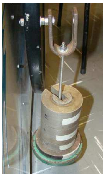
Figura 4.29 – Suporte para pesos instalado para calibração estática.
