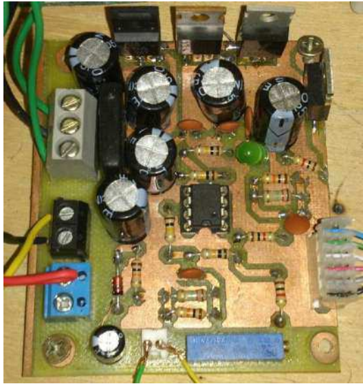
Figura 4.21 – Placa fabricada para o sistema da célula de carga.
