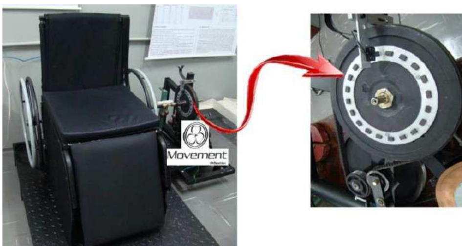
Figura 3.4 – Encoder projetado e instalado no protótipo ERG-CR09.
