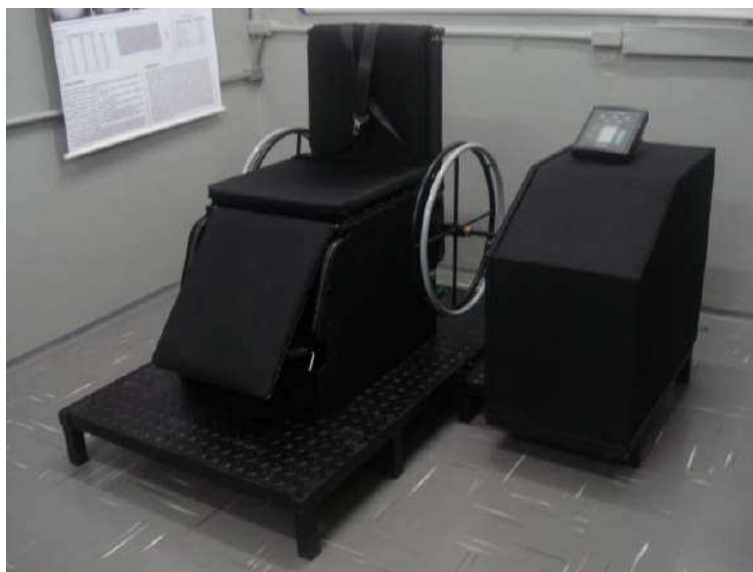
Figura 1.1 – Primeiro ergômetro (ERG-CR09) para cadeirantes projetado e construído no LPM.
