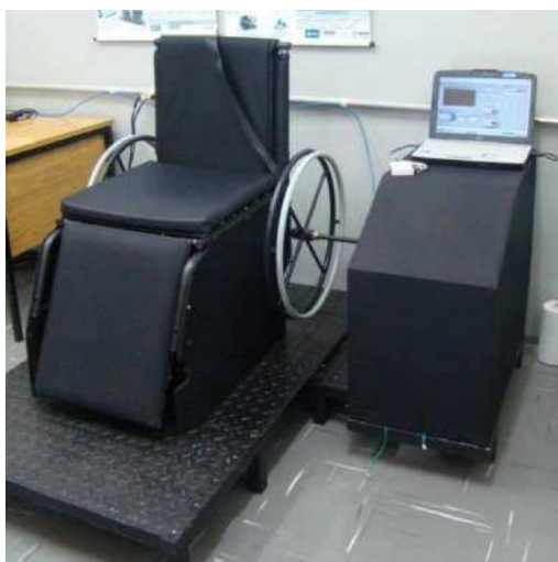
Figura 3.5 – Protótipo ERG-CR09 com ambos os módulos e conectado ao computador executando o software de controle. Fonte: Salgado (2009).
