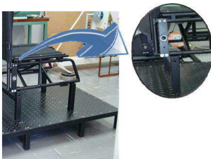
Figura 3.1 – Estrutura do assento e detalhe do mancal do eixo dos aros de propulsão. Fonte: Novais (2009).
