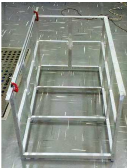
Figura 4.9 – Estrutura fabricada em alumínio com trilho de ajuste do assento posicionado para futura instalação.
