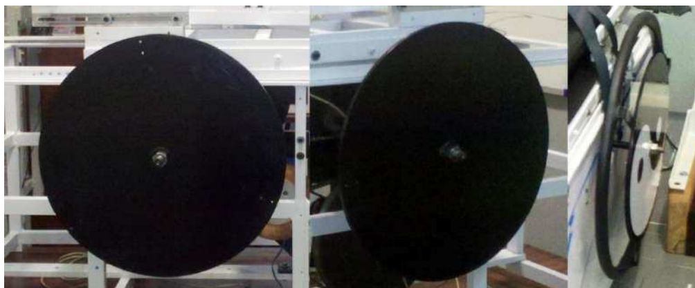
Figura 4.7 – Volantes projetados e instalados na estrutura do ergômetro.
