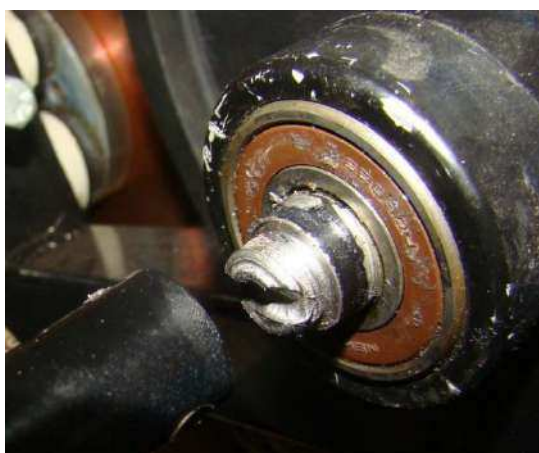
Figura 4.35 – Falha do eixo de 17 mm de diâmetro.
