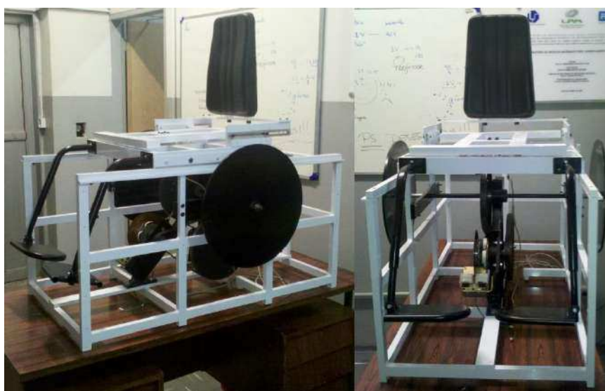
Figura 4.12 – Módulo de resistência eletromagnética, assento e encosto montados na estrutura base do ergômetro com primeiro volante projetado.
