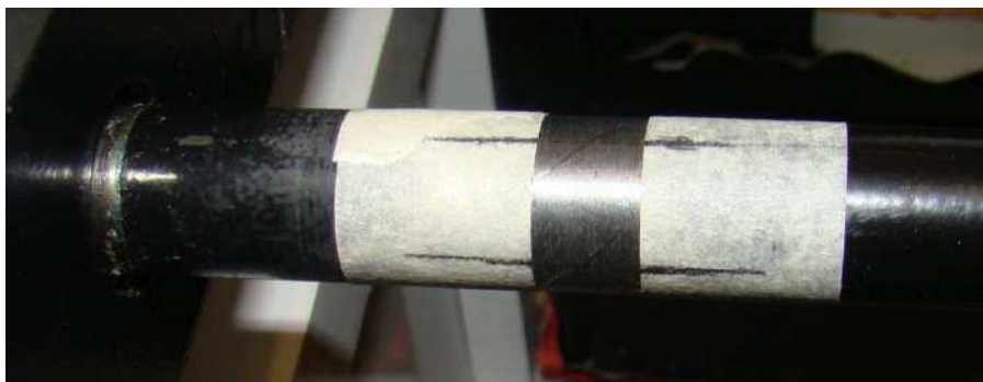
Figura 4.24 – Resultado da delimitação das posições dos extensômetros.
