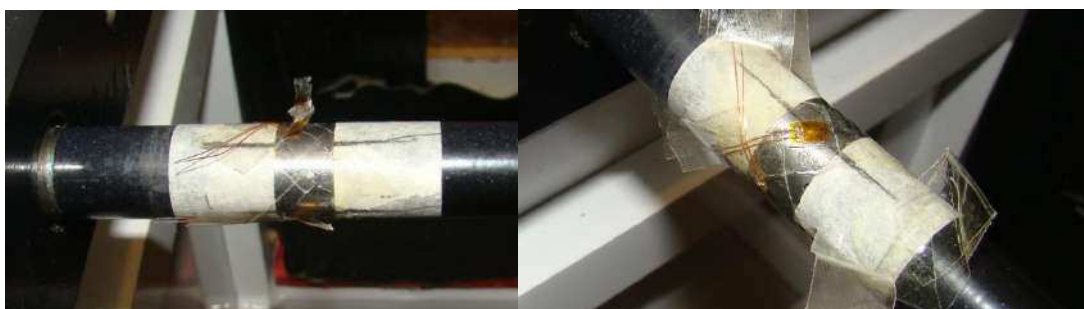
Figura 4.25 – Aplicação da cola no eixo e fixação permanente dos extensômetros.
