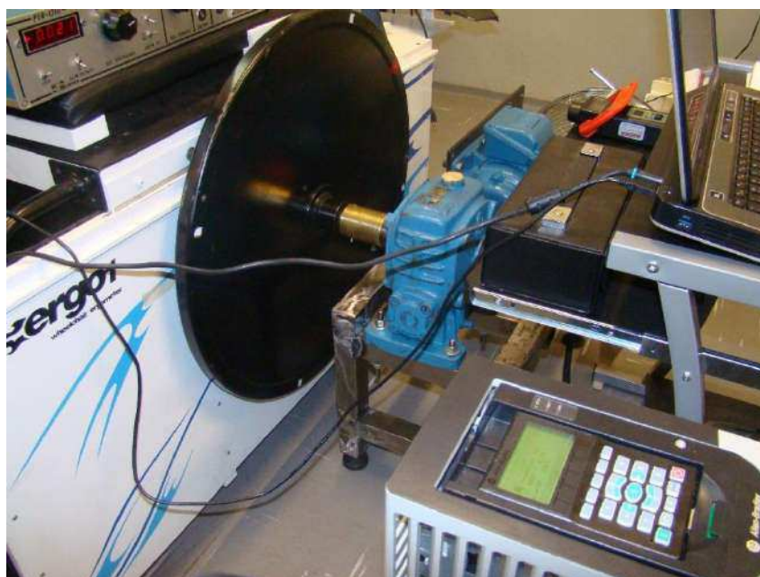
Figura 3.43 – Montagem para aferição da velocidade.
