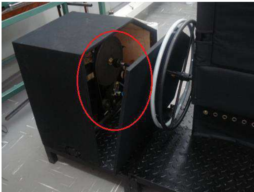
Figura 1.2 – Módulo de resistência eletromagnético do primeiro ergômetro projetado.
