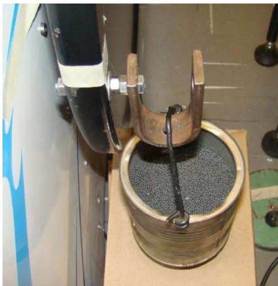
Figura 4.32 – Montagem do suporte no aro de propulsão com recipiente preenchido com esferas de chumbo.
