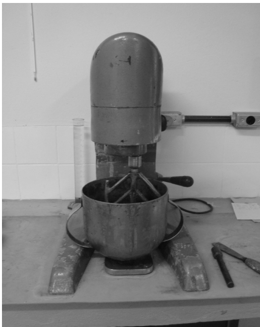
Figura 16 - Foto do misturador mecânico usado no preparo das argamassas.
