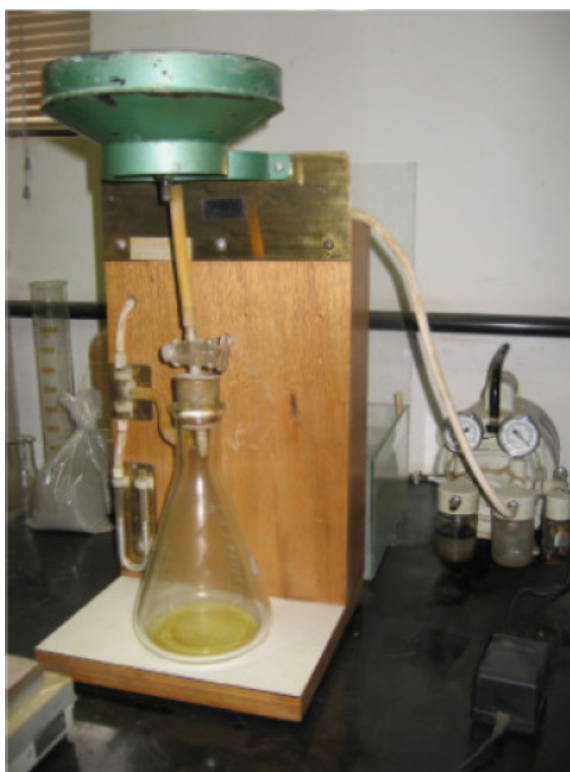
Figura 18 - Aparelhagem para determinação da retenção de água em argamassas.
