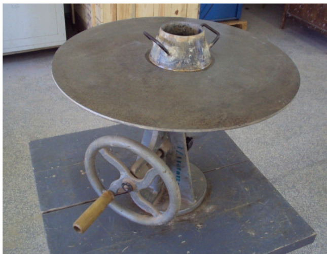
Figura 17 - Foto da Mesa de Abatimento utilizada no ensaio de Índice de Consistência.
