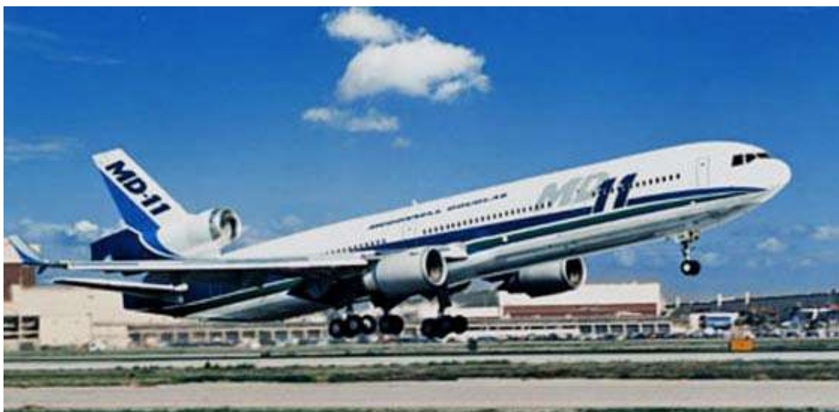
Figura 4 - MD-11 com Winglets desenvolvidos pela NASA (Fonte: www.widebodyaircraft.nl ).
