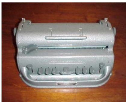
Figura 2 - máquina de datilografia de sete teclas (Perkins).
