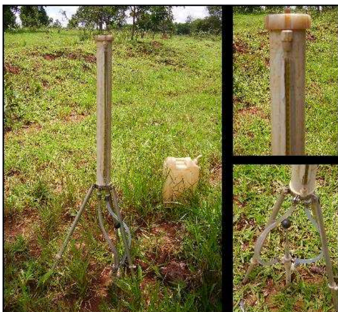
FIGURA 04: Permeâmetro de Guelph - Ensaio de infiltração realizado na estação experimental Boa Vista Autor: VIEIRA, W.C. - 2006
