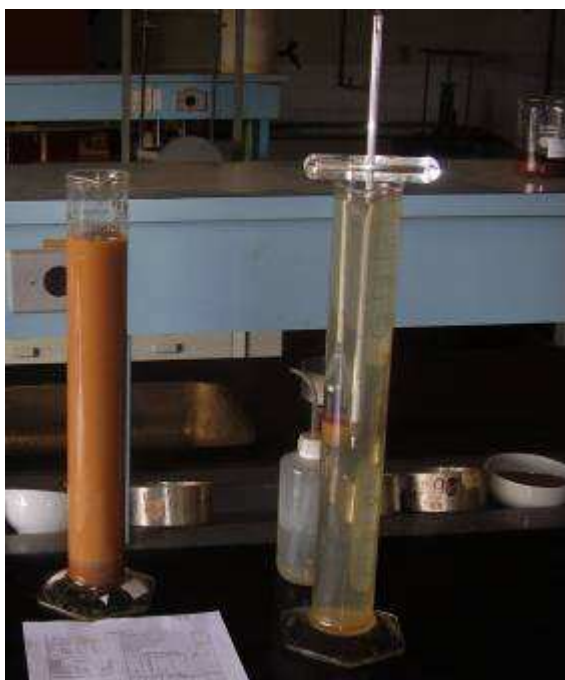
FIGURA 08: Ensaio de sedimentação do solo – Amostra: Estação Experimental Boa Vista/ Seção I. Autor: VIEIRA, W.C. - 2006
