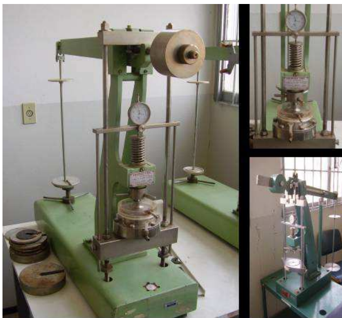
FIGURA 7: Ensaio de adensamento do solo realizado em amostra coletada na estação experimental Boa Vista Autor: VIEIRA, W.C. - 2006
