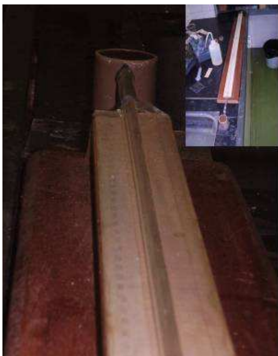
FIGURA 05: Aparelho utilizado para o ensaio de absorção de água. Autor: VIEIRA, W.C. - 2006
