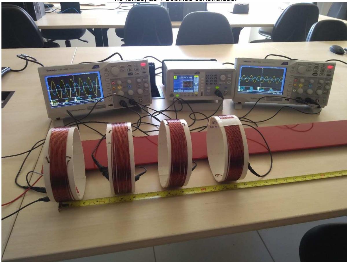
Figura 36- Configuração usada para experimentação, mostrando o osciloscópio, o gerador de sinal e, no fundo, as 4 bobinas construídas.
