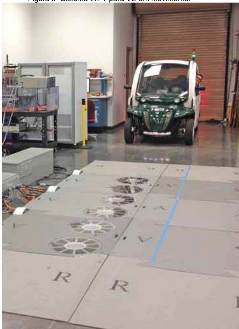
Figura 9- Sistema WPT para VE em movimento.
