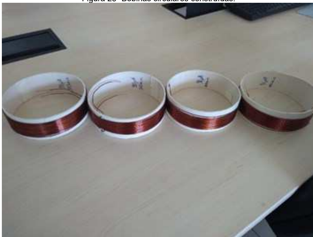
Figura 25 -Bobinas circulares construídas.
