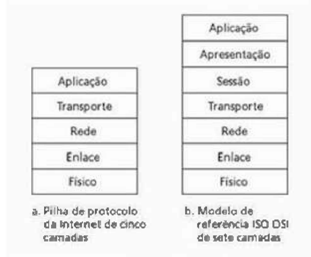
Figura 4 – Pilha de protocolo de Internet e modelo de referência OSI
