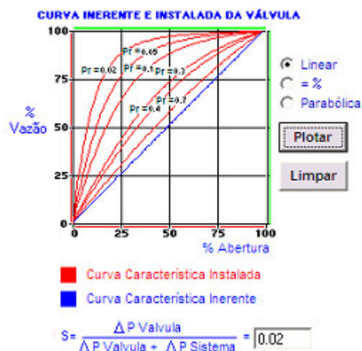
Figura 2.13 – Família de curvas instaladas de uma válvula com característica inerente linear
