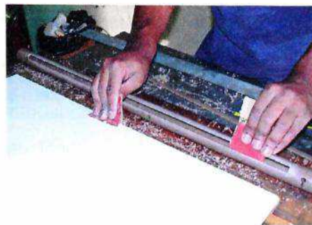
Figura 2.2 - Lixamento e limpeza das superfícies
