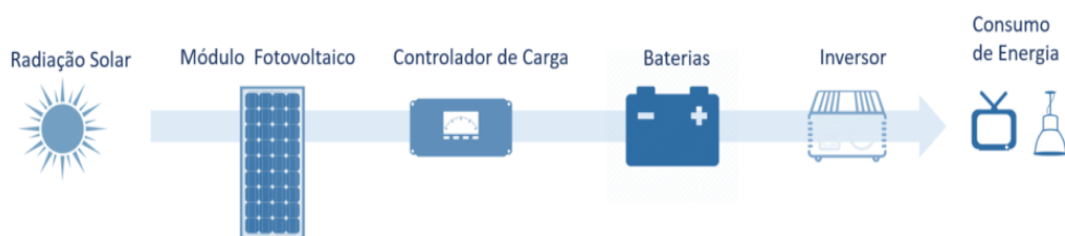
Figura 10 - Sistema Fotovoltaico Isolado
