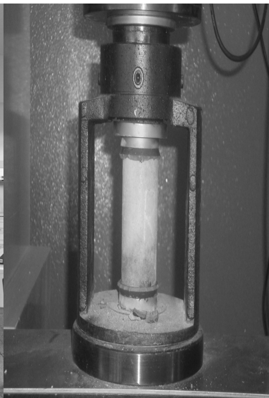
Figura 16: (a) Máquina de ensaio mecânico de compressão e (b) corpo-de-prova da argamassa com o polímero (SAC 1,00) no momento do rompimento.
