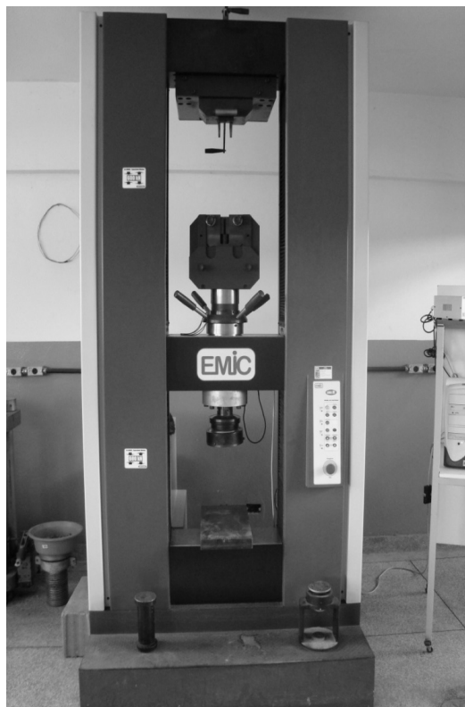
Figura 16: (a) Máquina de ensaio mecânico de compressão e (b) corpo-de-prova da argamassa com o polímero (SAC 1,00) no momento do rompimento.
