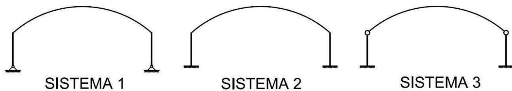
Figura 11 - Sistemas estruturais: esquema estático
