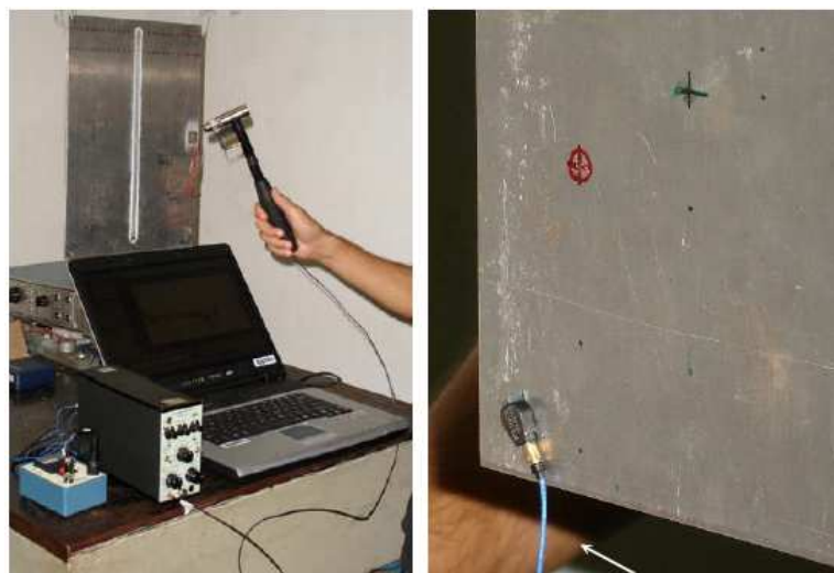
Figura 2.1 – Montagem experimental para aquisição de FRF (Bezerra, 2006).
