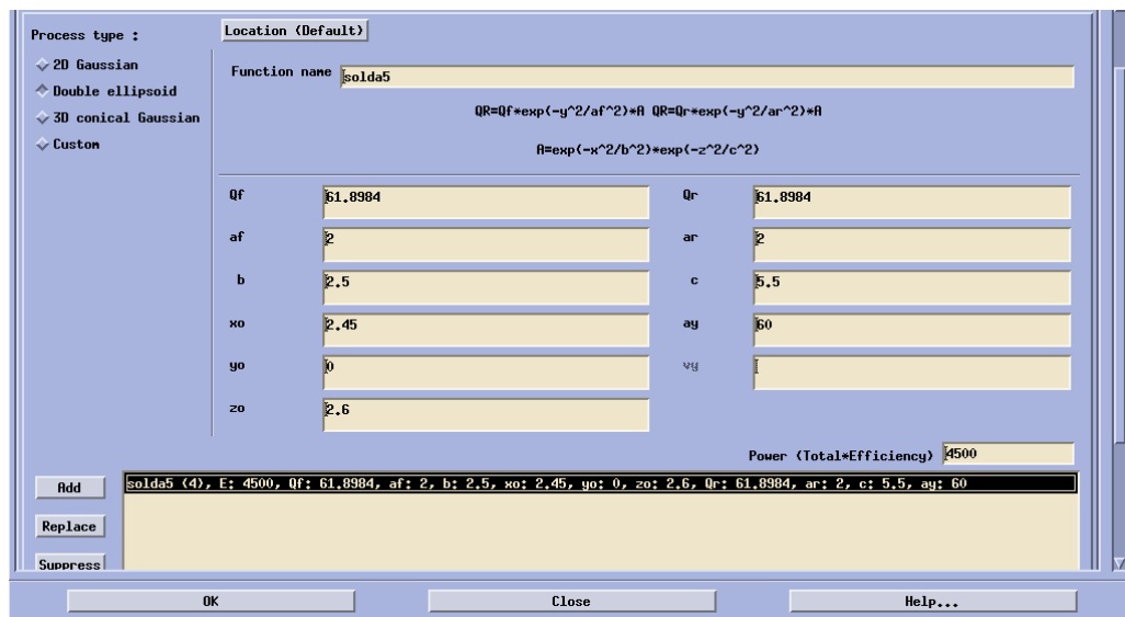
Figura 4.4 – Parâmetro de ajuste no Syswel® para a simulação da fonte para solda 5
