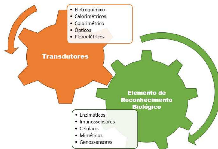
Fig. 06 - Esquema de diferentes categorias de biossensores: o elemento de reconhecimento biológico e de transdutores (fonte: autoria própria).
