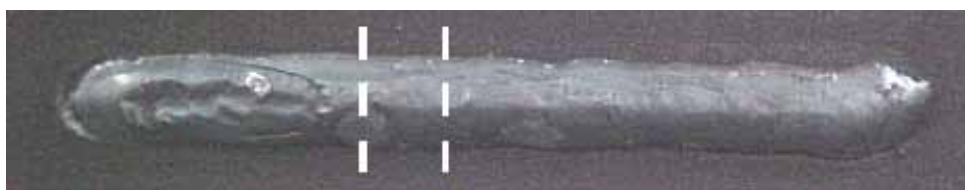
Figura 3.13 – Posição de corte das amostras no corpo de Prova
