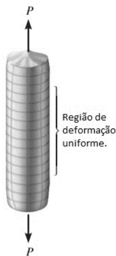
Figura 2.2 - Região de deformação uniforme em uma viga perante uma carga axial.
