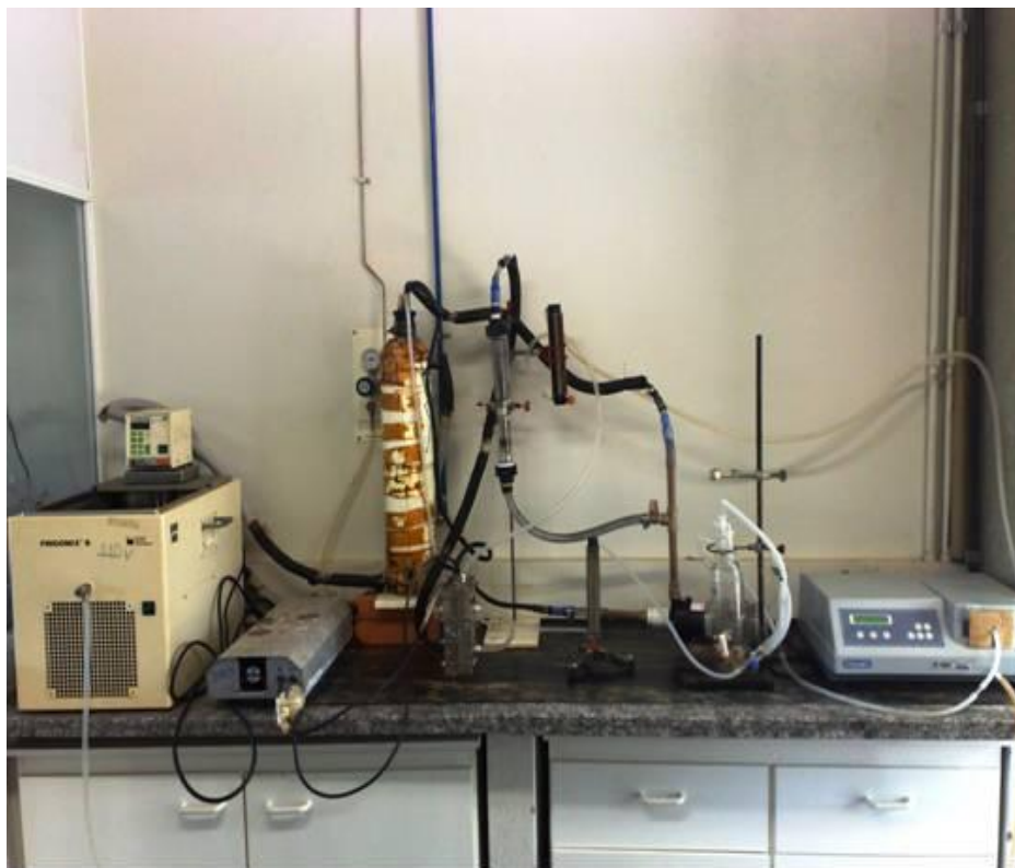
Figura 11- Fotografia do conjunto experimental empregado na geração eletroquímica de O_3 .
