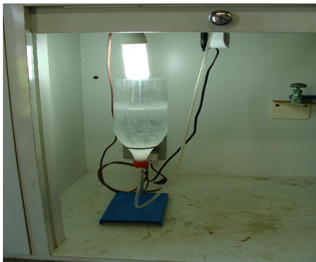
Figura 14- Fotografia do conjunto experimental empregado nas avaliações de toxicidade.
