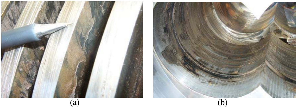
Figura 2.6 - Aspecto geral do desgaste em rotor e carcaça de bomba multifásica após 200 horas de trabalho, (a) marcas de desgaste e destacamento de camada no filete do parafuso, (b) superfícies internas da carcaça mostrando sinais de contato e aquecimento (Fonte: PETROBRAS, Abril de 2001).
