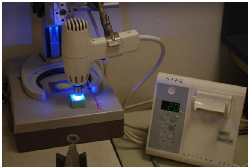
Figura 2. Unidade fotopolimerizadora de luz halógena posicionada a 1 cm da superfície a ser fotoativada.
