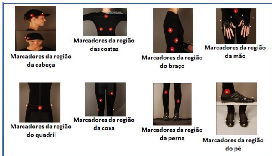
Figura 3.3: Localização dos marcadores corporais de acordo com sistema de marcação do software ARENA™ Motion Capture.
