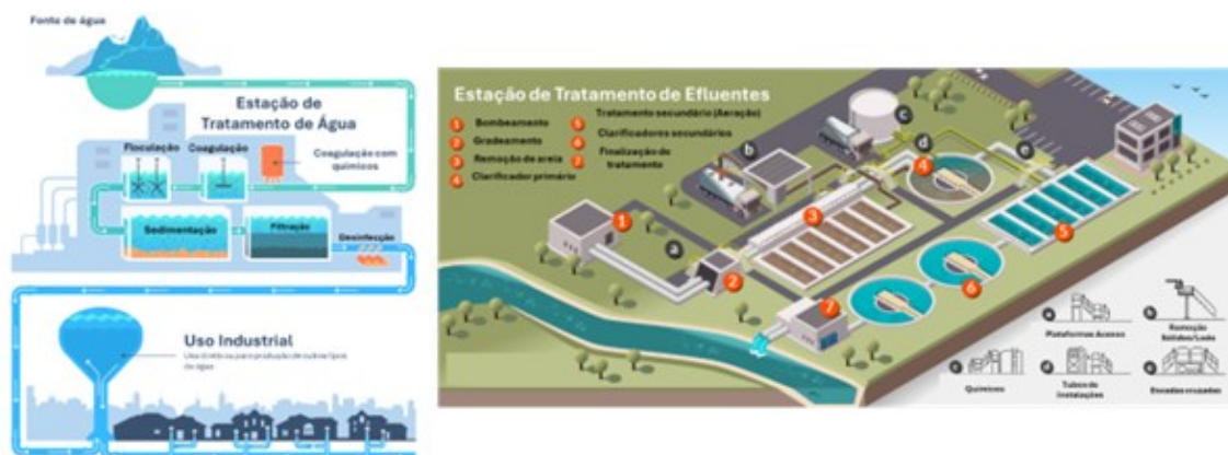
Figura 19: Processos de tratamento de água e efluentes em uma planta de celulose e papel.
