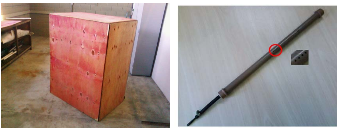
Figura 6.15 - Sistemas utilizados para os tratamentos propostos (da esquerda pra direita: enclausuramento e tubo de PVC com quatro furos).
