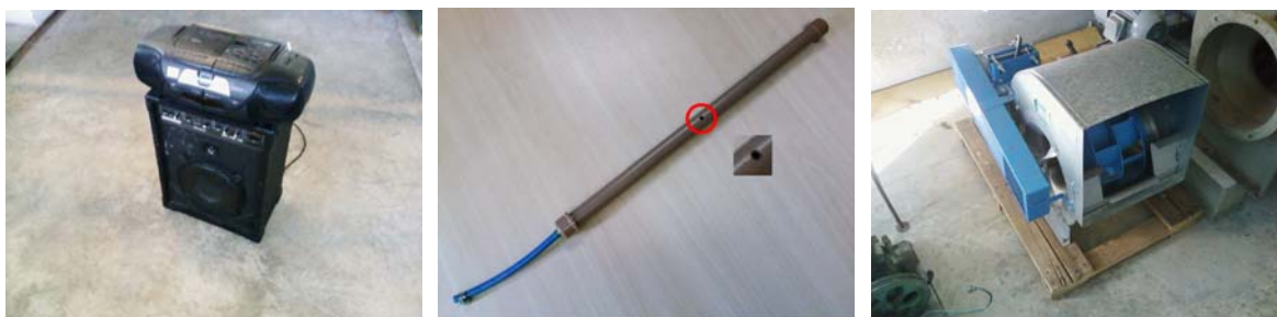
Figura 6.13 - Equipamentos utilizados para os ensaios (da esquerda para direita: caixa de som, tubo de PVC com 1 furo e ventilador industrial)
