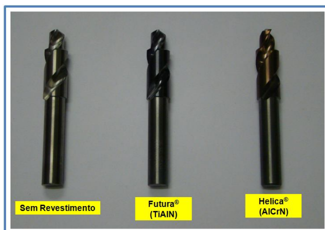
Figura 3.7 – Revestimentos utilizados nas brocas escalonadas helicoidais.
