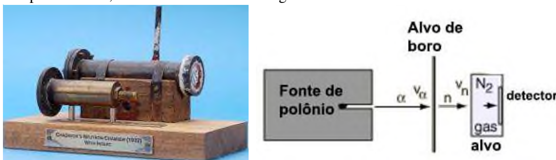
FIGURA 7 – (a) Foto do real experimento utilizado por Chadwick. (b) Modelo esquemático do experimento de Chadwick mostrando a fonte emissora de partículas alfa (polônio), o anteparo de boro, e a câmara contendo nitrogênio e o detector.
