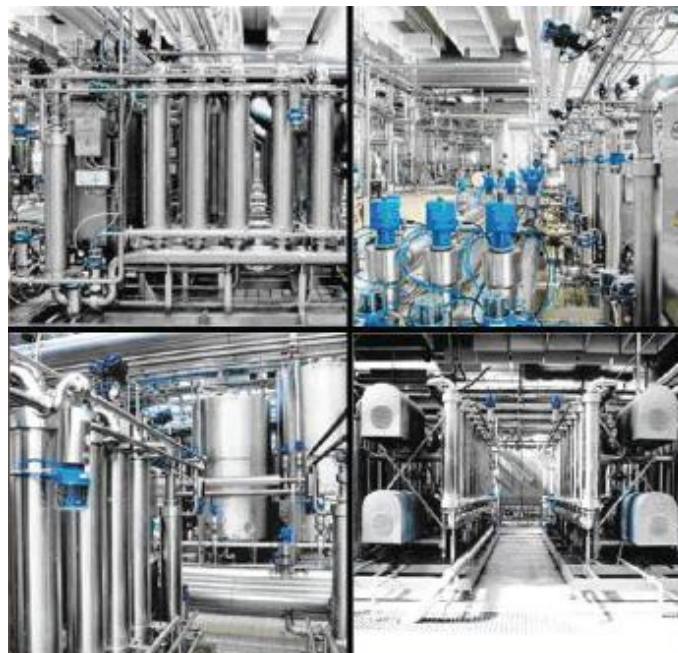
Figura 2.9 - Sistema de membranas de fibra oca de PES desenvolvido pelas empresas Pall e Gea Westfalia. Fonte: < http://www.meiofiltrante.com.br/edicoes.asp?id=713&link=ultima&fase=C&retorno=b >.
