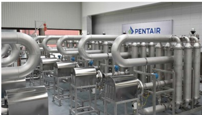
Figura 2.10 - Sistema de membranas de fibra oca de PES desenvolvido pela empresa Pentair.
