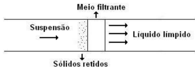
Figura 2.1 – Princípio do funcionamento de um filtro. Fonte:
