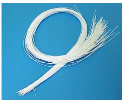
Figura 2.6 - Feixe de membranas microporosas de geometria cilíndrica do tipo fibra oca. Fonte: < http://bjft.ital.sp.gov.br/artigos/brazilianjournal/ed_especial/23.pdf >.
