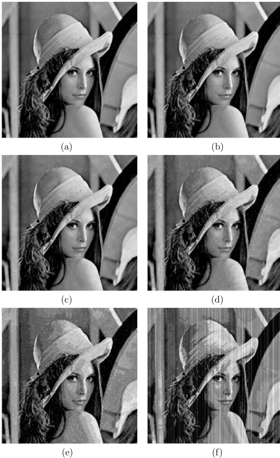
Figura 5.7: Exemplo de perda da qualidade visual. (a) imagem original; (b), (c), (d), (e), (f) imagens marcadas pela técnica de Wu e Shih [11] com VSTW = 16, 8, 4, 2 e 1 , respectivamente. Alteração no 6º LSB do pixel (1,1) de cada bloco, indicada pelo parâmetro de entrada QF(1,1) = 32 e QF(i,j) = 1 , para todos i \neq 1 e todos j \neq 1 .
