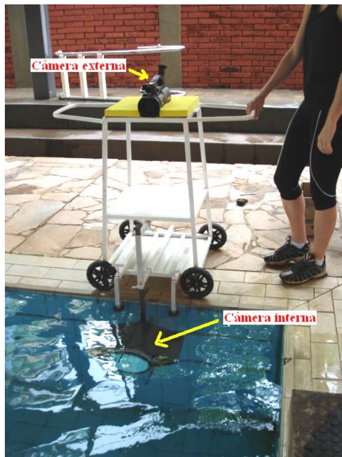
Figura 3.2. Foto do suporte ilustrando o local da câmera de vídeo externa e da interna.
