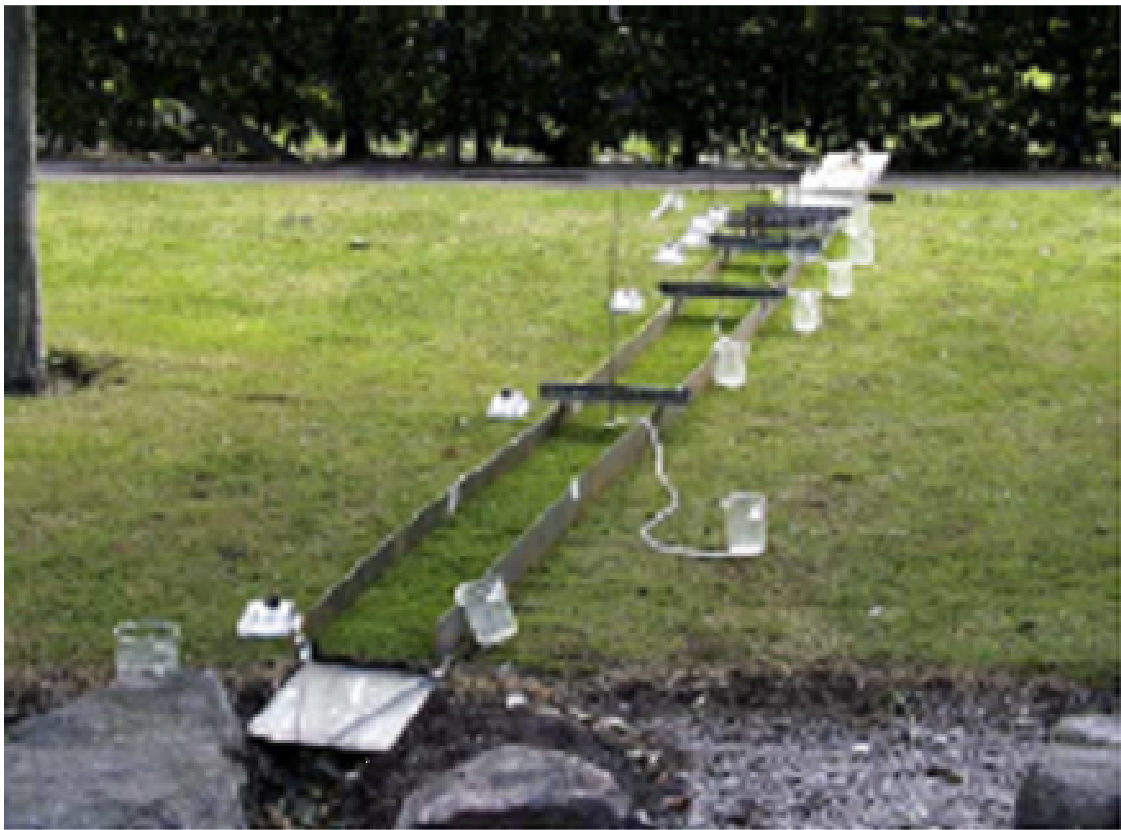
Figura 2.11 - Experimento de remoção de poluentes em grama. Fonte: Deletic; Fletcher, 2006, p. 264.
