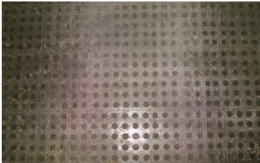
Figura 3.2-2: Placa distribuidora utilizada nos testes.
