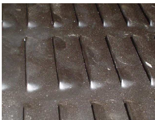
Figura 3.3-3: Primeira placa distribuidora testada no leito.
