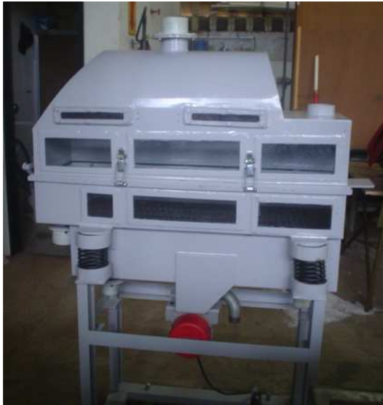
Figura 3.2-1: Esquema do leito vibro-fluidizado.
