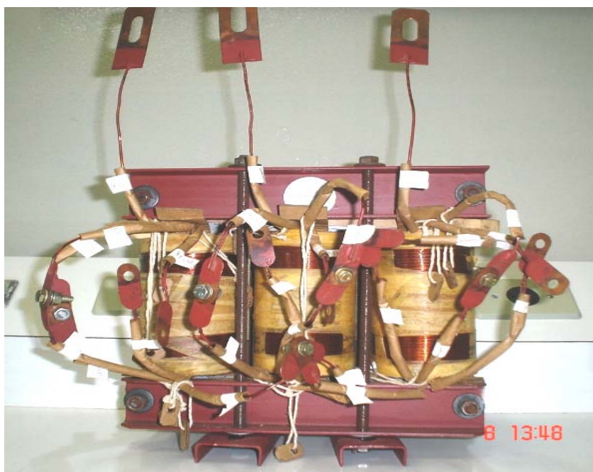
Figura 4.15 - Protótipo do filtro eletromagnético de sequência positiva e negativa
