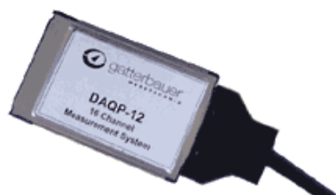
Figura 4.5 - Foto ilustrativa do cartão de aquisição de dados DAQP-12
