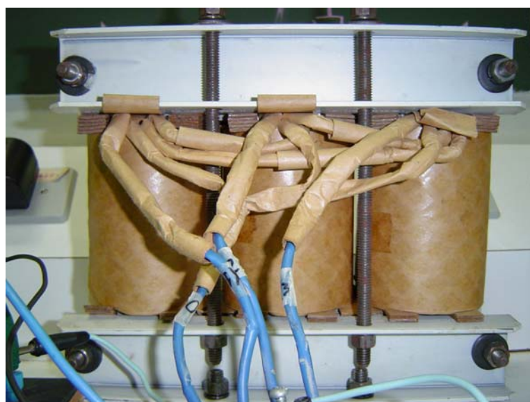
Figura 4.1 - Protótipo do filtro eletromagnético de seqüência zero
