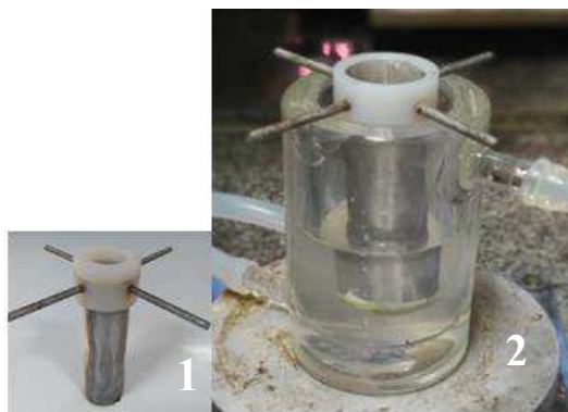
Figura 3.3- Reator com cesta de aço inox para imobilização. 1: cesta de aço inox; 2: reator.
