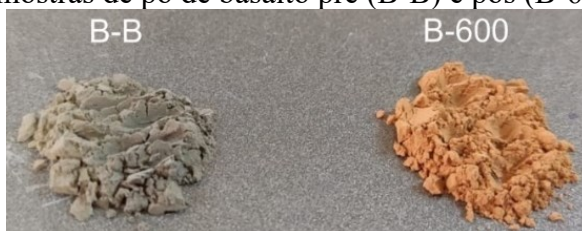
Figura 34 - Foto das amostras de pó de basalto pré (B-B) e pós (B-600) tratamento térmico.
