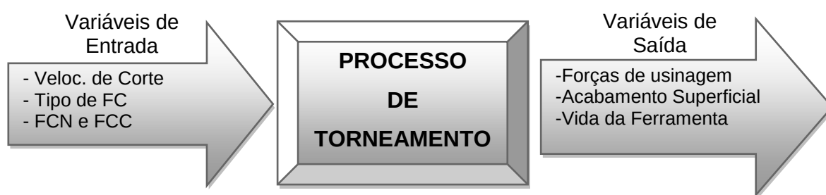
Figura 3.14 - O processo de torneamento pode ser representado por uma função ligando as variáveis de entrada (esquerda) às variáveis de saída (direita)
