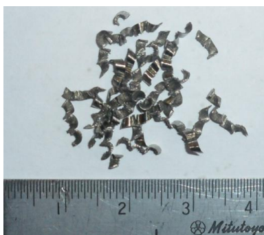
Figura 4.18 - Cavaco contínuo na forma de arco
