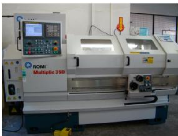
Figura 3.8 - Torno CNC Romi Multiplic 35D utilizado nos teste de torneamento (PEREIRA, 2009)
