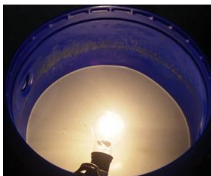
Figura 3.5 - Esquema utilizado para manter o fluido com temperatura favorável para o crescimento bacteriano (na imagem FCC-B)
