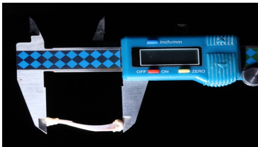
Figura 1: Paquímetro digital medindo comprimento próximo-distal de tíbia.
