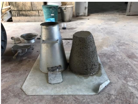
Figura 18 – Slum flow test (concreto convencional)
