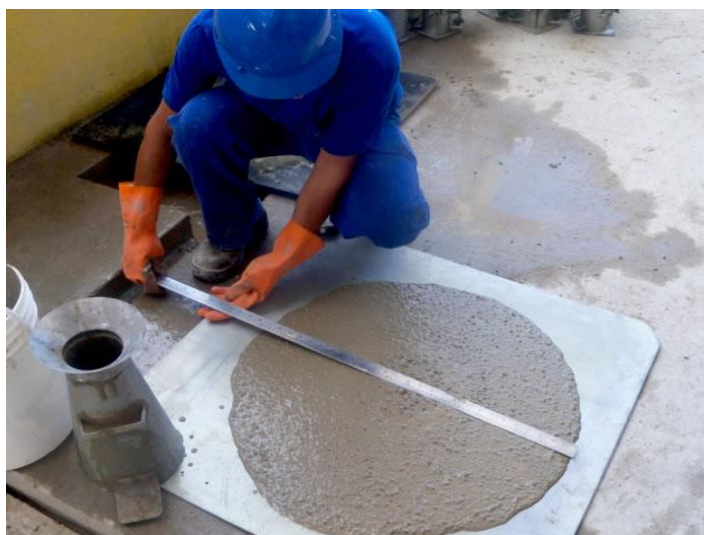
Figura 20 – Slump flow Test, concreto auto adensável
