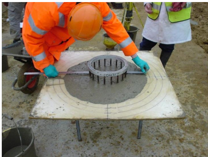
Figura 21 – J-ring test, concreto auto-adensável
