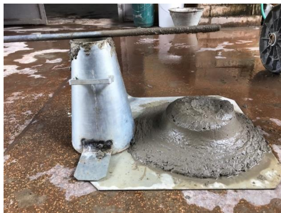
Figura 19 – Slump flow test (concreto com aditivo incorporador de ar 3 )
