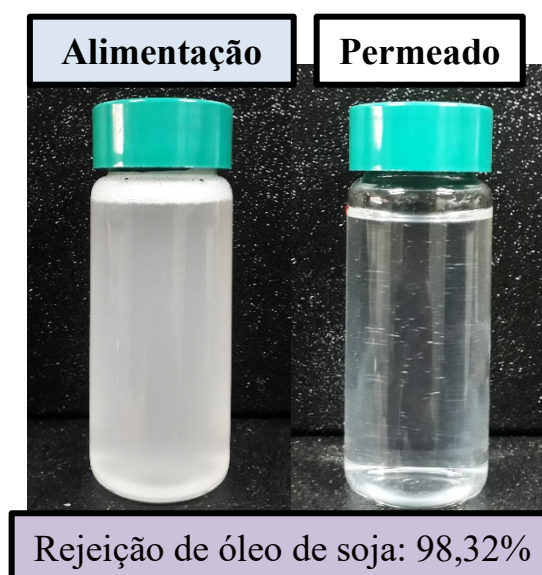
Figura 49 - Dados de (a) fluxo experimental e calculado, e (b) Aspecto visual e fotografias microscópicas da emulsão de óleo de soja em água, obtidos com a filtração realizada com a fibra HF-Si (45%).
