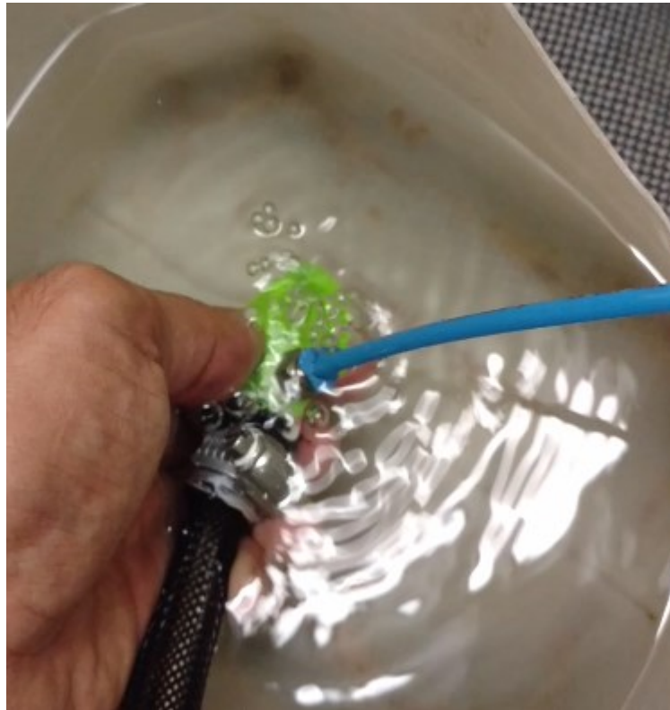
Figura 19. Teste de estanqueidade das válvulas.
