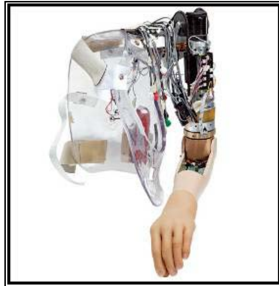
Figura 2.3 - Controle neurológico para braço biônico [TELEGRAPH, 2007]
