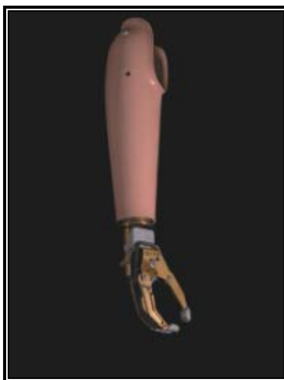
Figura 2.5 – Prótese Mioelétrica sem a luva de revestimento [ACTIVE, 2007].
