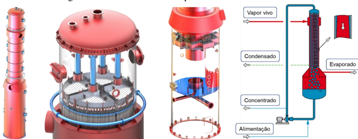
Figura 27 – Detalhes em um evaporador de filme descendente.
