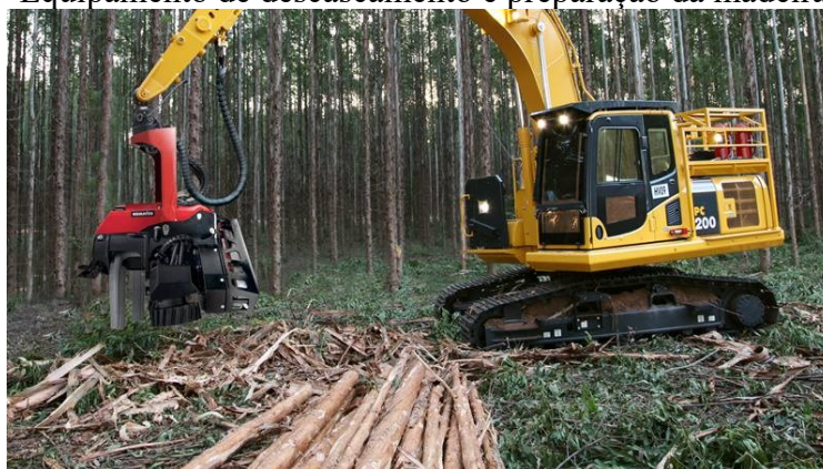
Figura 13 – Equipamento de descascamento e preparação da madeira na floresta.
