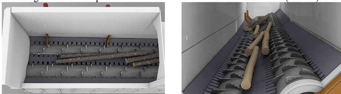
Figura 14 – Princípio de funcionamento de descascadores de rolos (tambor).
