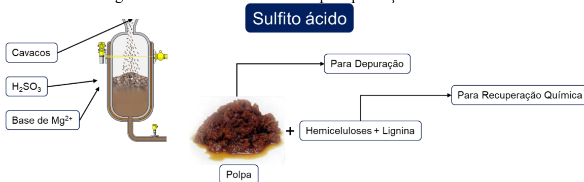
Figura 18 – Método sulfito ácido para produção de celulose.
