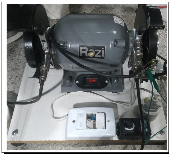
Figura 3.1 – Motor esmeril + bancada + sensor fotoelétrico ( rotor-kit )
