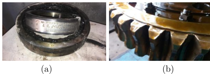
Figura 1.3 – Desequilíbrios por: (a) - Desgaste de rolamentos e (b) - Desgaste de engrenagens
