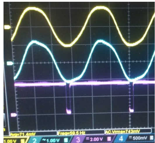
Figura 4.2 – Sinal com a introdução de uma massa de desequilíbrio
