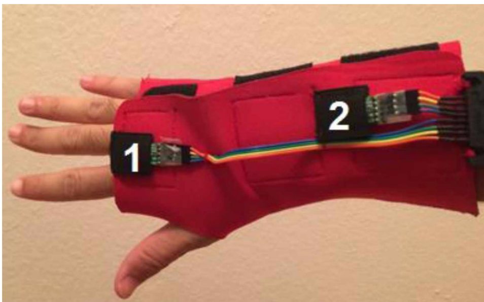
Figura 2: Posicionamento de sensores inerciais. A unidade 1 está posicionada na mão, enquanto a unidade 2 está posicionada no antebraço.
