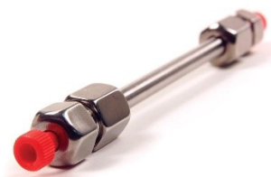
Figura 6. Coluna em aço inoxidável usadas no trabalho, 50 mm \times 4,0 mm d.i.
