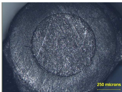
Figura 3.24. Imagem ampliada cinco vezes do microdispositivo contendo ET de compósito de grafite na composição otimizada (circunferência interna). A circunferência externa é a ponteira de micropipeta.
