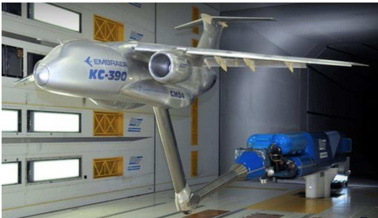
Figura 1.1 – Ensaio em Túnel de Vento de protótipo da Aeronave EMBRAER KC-390
