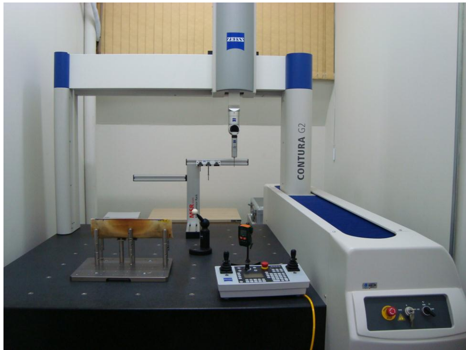
Figura 3.1- MM3C utilizada no desenvolvimento do trabalho, fabricada pela Carl Zeiss, modelo Contura G2 RDS/XXT
