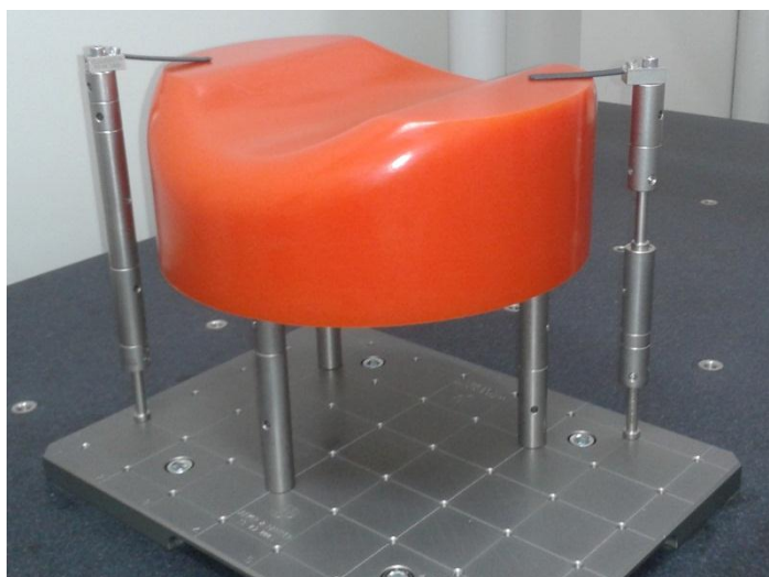
Figura 4.14 – Fixação de uma amostra nova de enrijecedor para riser de 6 in (152,4 mm) de diâmetro interno
