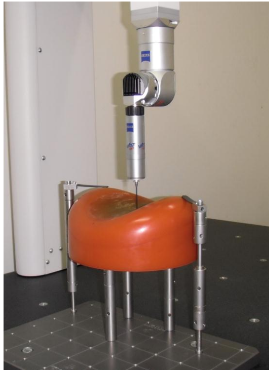
Figura 3.7 - Fixação de uma amostra de enrijecedor, após testada no tribômetro durante 1.280 horas
