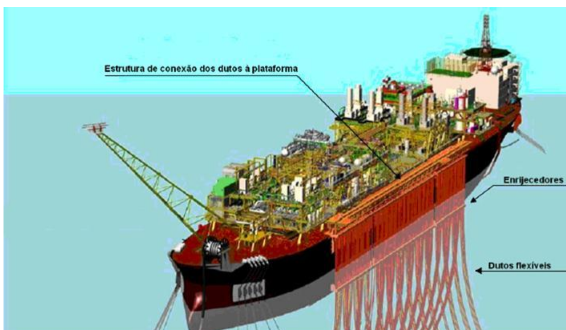
Figura 1.4 - Visão geral do projeto da plataforma P50 de ancoragem do tipo spread-mooring , em que os risers ficam distribuídos na lateral da embarcação (RAMOS NETO, 2010 apud LADEIRA, 2011)
