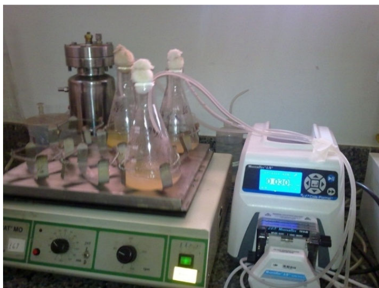
Figura 4.1- Processo em batelada alimentada
