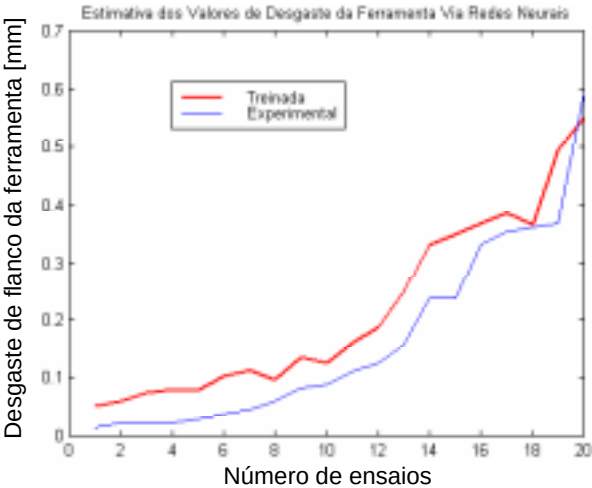
Figura 7.8 – Ajuste dos valores de VB_{Bmax} realizado a partir do arquivo de dados originado pelas dez primeiras condições de corte da Tabela 5.1.
