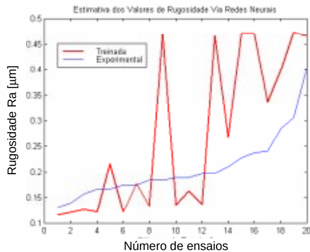
Figura 7.15 – Ajuste dos valores de Ra realizado a partir do arquivo de dados originado pelas oito primeiras condições de corte da Tabela 5.1.
