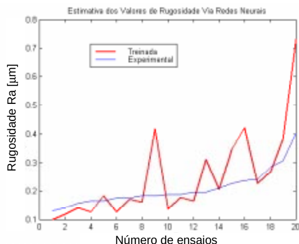
Figura 7.16 – Ajuste dos valores de Ra realizado a partir do arquivo de dados originado pelas nove primeiras condições de corte da Tabela 5.1.
