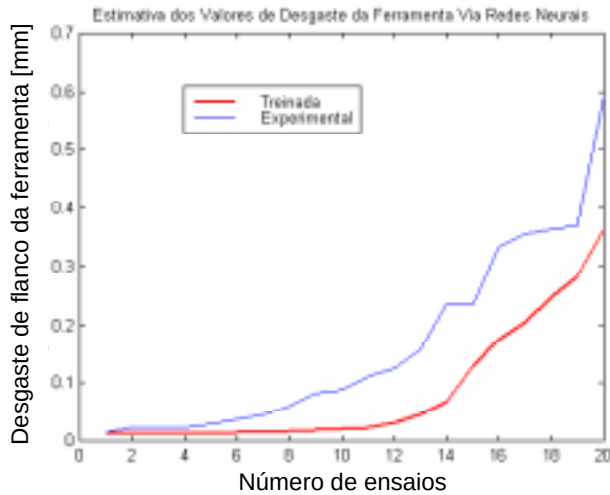
Figura 7.4 – Ajuste dos valores de VB_{Bmax} realizado a partir do arquivo de dados originado pelas seis primeiras condições de corte da Tabela 5.1.
