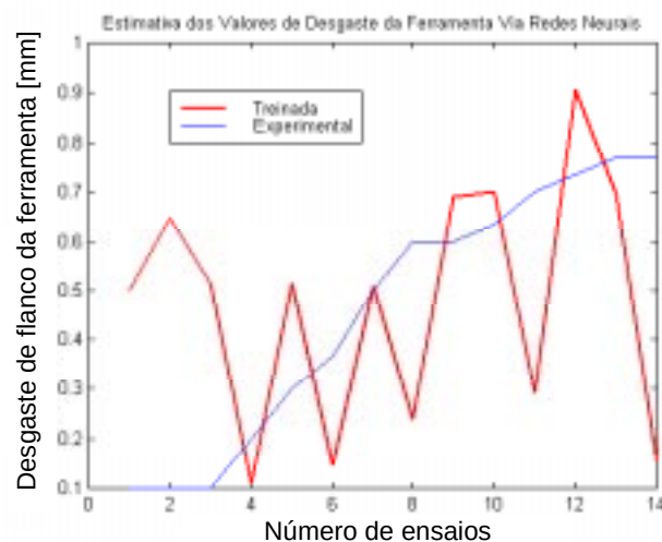
Figura 7.21 – Ajuste dos valores de VB_{Bmax} realizado a partir do arquivo de dados aleatório.
