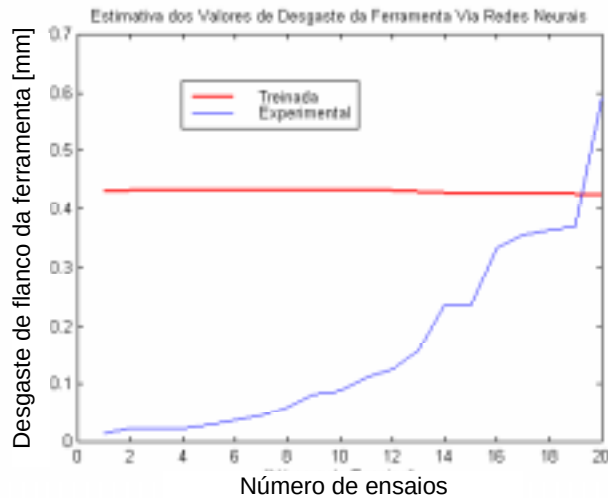
Figura 7.3 – Ajuste dos valores de VB_{Bmax} realizado a partir do arquivo de dados originado pelas cinco primeiras condições de corte da Tabela 5.1.
