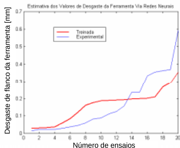
Figura 7.7 – Ajuste dos valores de VB_{Bmax} realizado a partir do arquivo de dados originado pelas nove primeiras condições de corte da Tabela 5.1.
