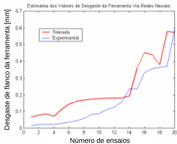
Figura 7.20 - Ajuste dos valores de desgaste das ferramentas VB_{Bmax} , realizado conforme esquema ilustrado na Figura 7.19.
