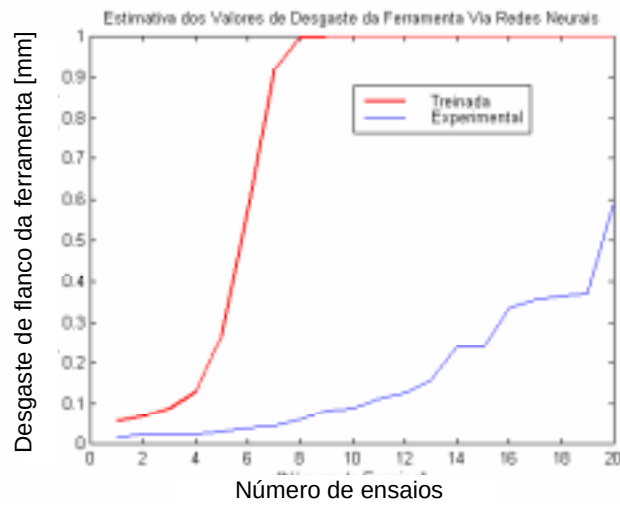
Figura 7.2 – Ajuste dos valores de VB_{Bmax} realizado a partir do arquivo de dados originado pelas quatro primeiras condições de corte da Tabela 5.1.
