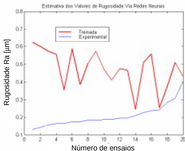
Figura 7.12 – Ajuste dos valores de Ra realizado a partir do arquivo de dados originado pelas cinco primeiras condições de corte da Tabela 5.1.
