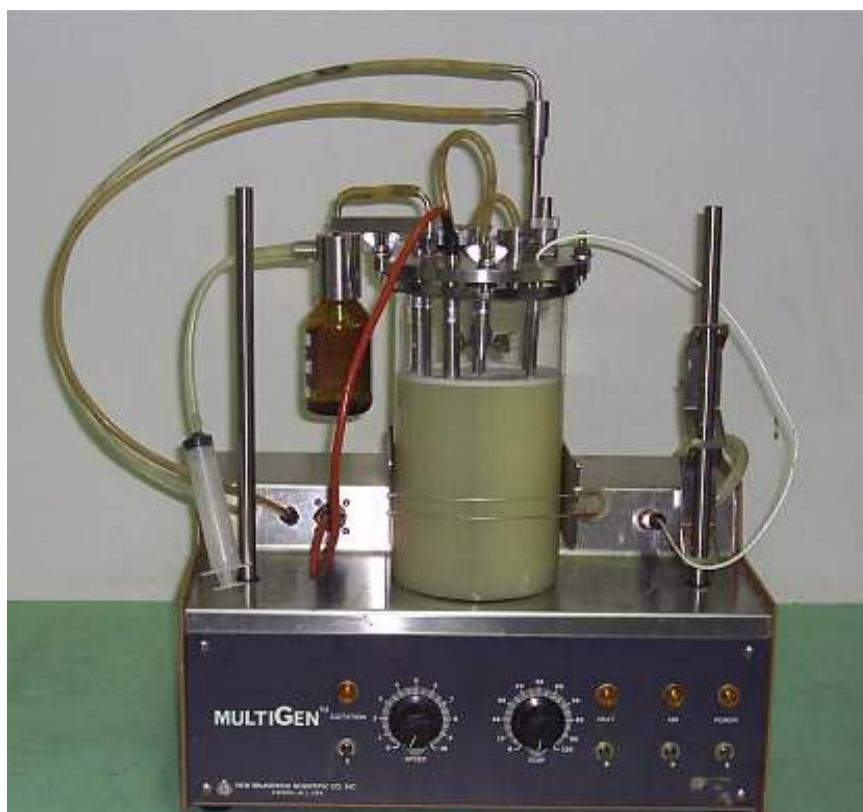
Figura 3-1: Reator utilizado para o estudo da hidrólise do soro de queijo
