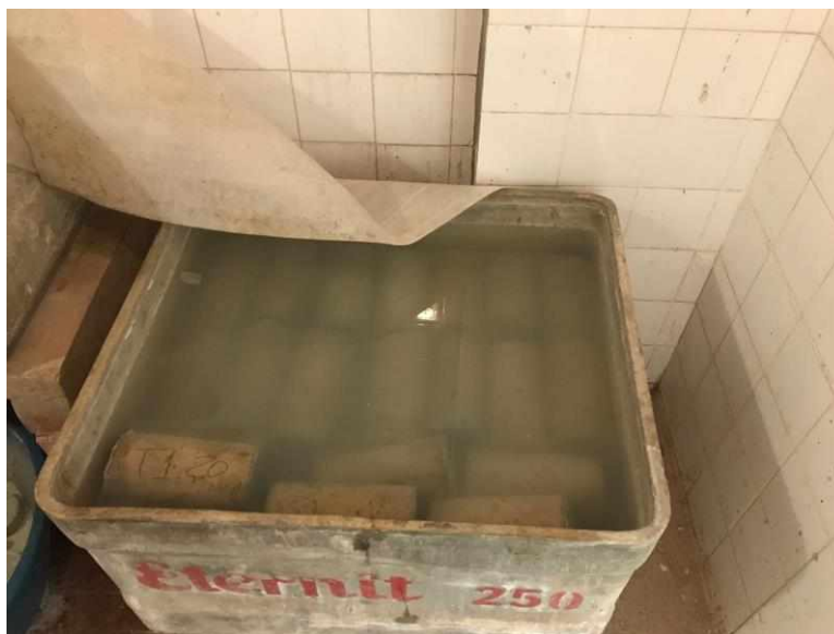
Figura 17 - Contaminação por \text{NaCl} do concreto
