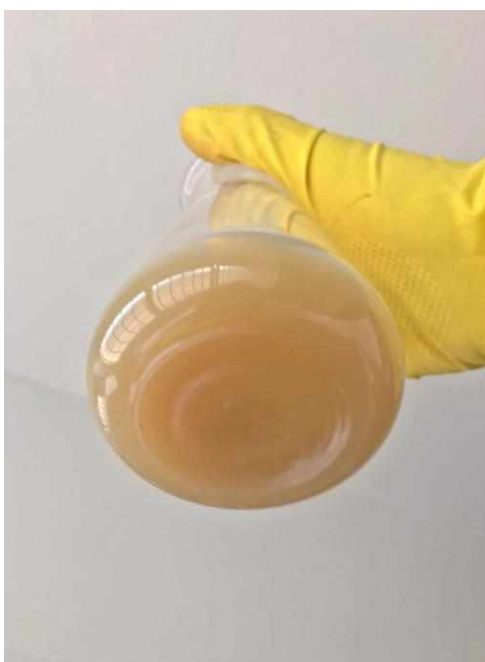
Figura 25 - Início da reação do \text{AgNO}_3 em contato com a solução com \text{K}_2\text{CrO}_4
