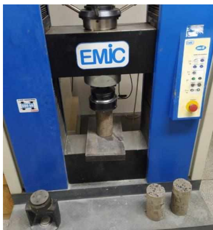
Figura 15 - Ensaio de resistência à compressão
