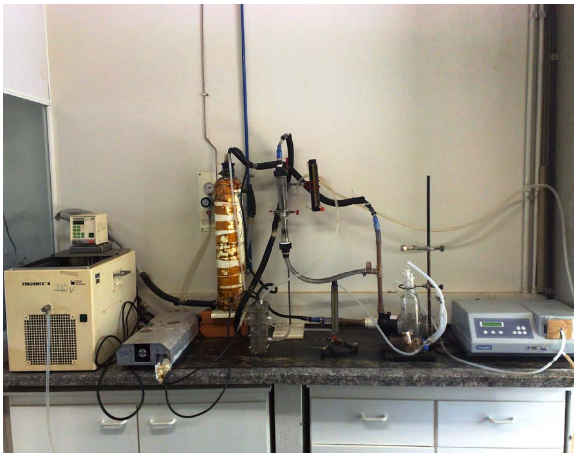
Figura 16: Fotografia do conjunto experimental empregado na geração eletroquímica de O_3 . Da esquerda para direita: sistema de refrigeração (banho ultratermostatzado), fonte de corrente contínua, frasco reservatório e separador de gases, reator eletroquímico, fluxômetro, bomba centrífuga, frasco reator e espectrofotômetro.
