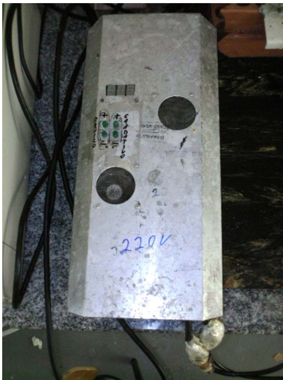
Figura 15: Fonte de corrente contínua (80A/12V) empregada no reator protótipo.
