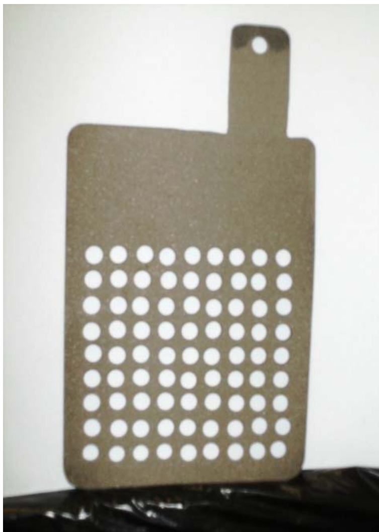
Figura 12: Suporte de titânio jateado e perfurado empregado no protótipo N°1 sem \beta\text{-PbO}_2 .
