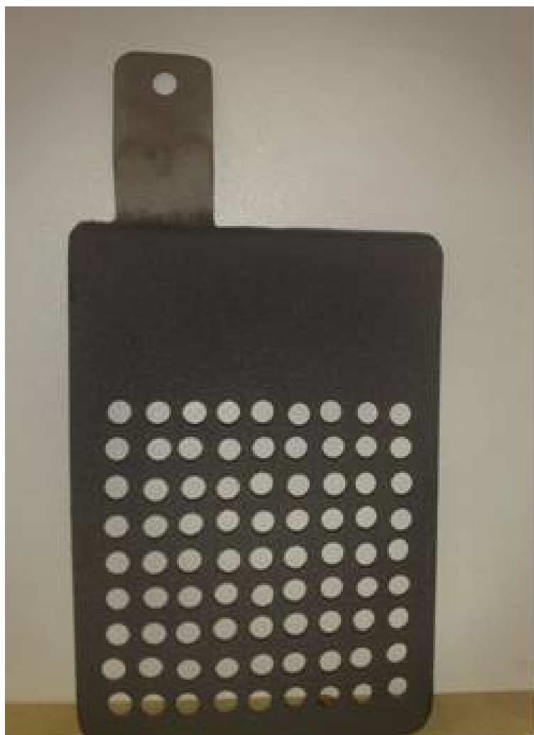
Figura 13: Suporte de titânio perfurado e eletrodeposição empregado no reator protótipo N°1.
